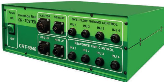
Устройство **FLAGMAN «CRTester. CRT-5040»** предназначен для диагностирования форсунок системы CommonRail производства фирм Bosch, Denso, Delphi, Siemens VDO на стенде. Проверка форсунок обеспечивается за счет подачи управляющего сигнала от контроллера на испытываемые форсунки и поддержания требуемого давления в системе согласно выбранному тест-плану.
